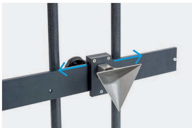
Lustro z podziałką do precyzyjnego ustawiania urządzenia
